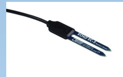
seniore per la misura del contenuto d'acqua volumetrico EC-5
